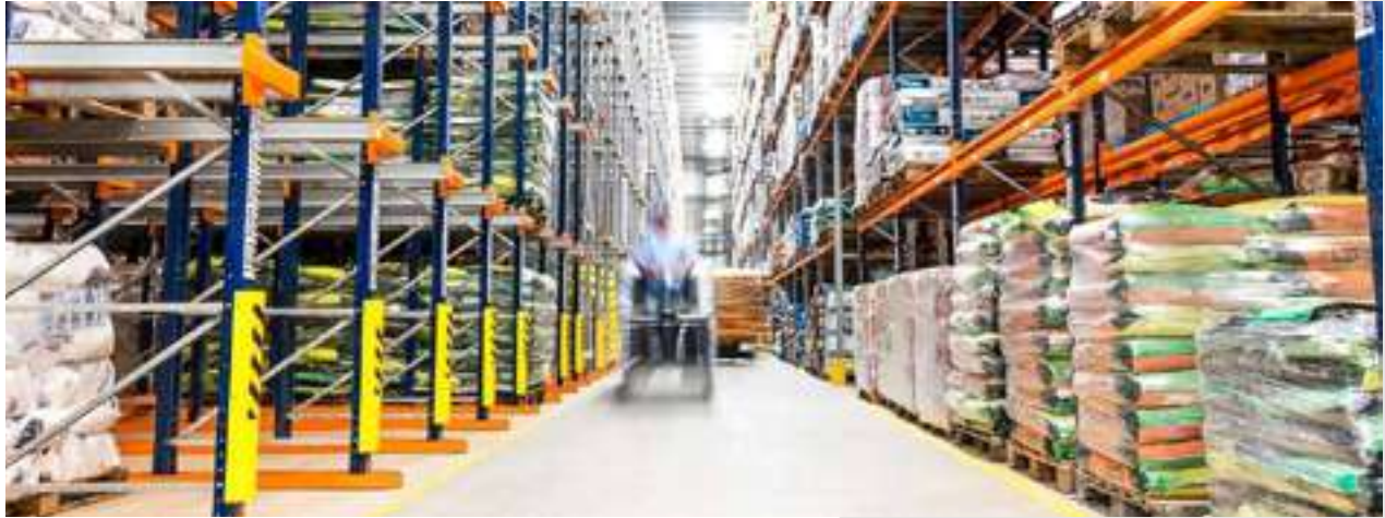
RACKS SELECTIVOS (CARGA PALETIZADA)
